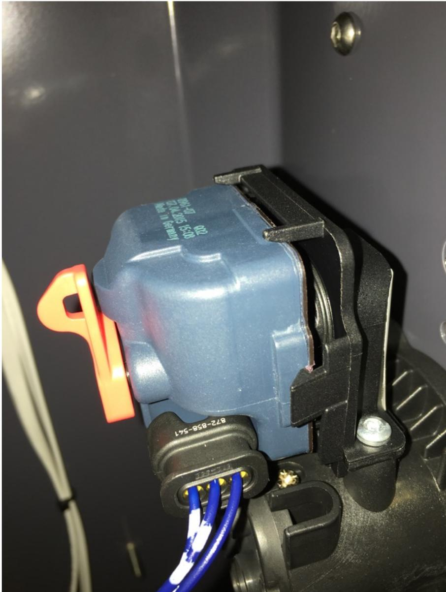
Remettre en place le moteur, en le pré-positionnant entre les ergots sans l'enfoncer complètement, de façon à ce qu'il soit aligné avec son support. Le moteur doit en effet entrer "droit" dans son logement.
