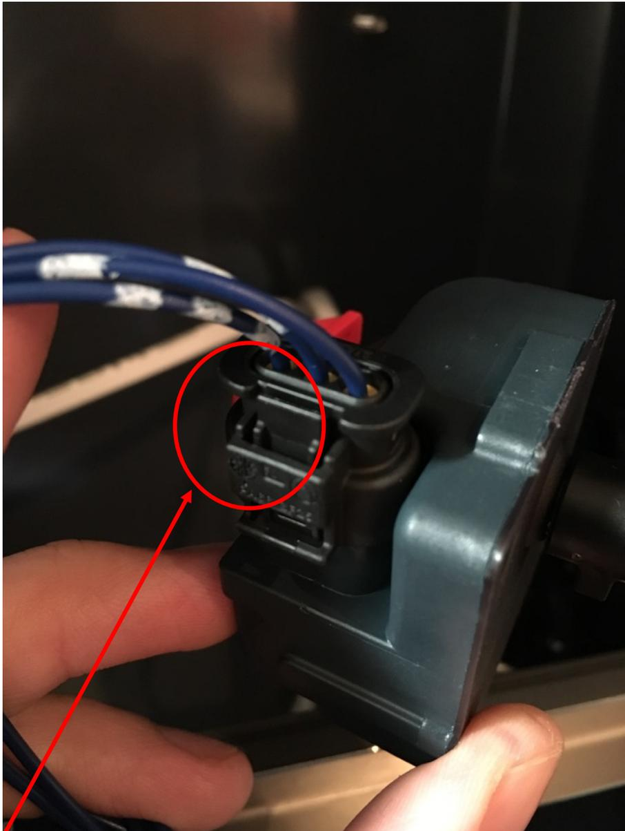
Cette languette verrouille le connecteur sur le moteur
