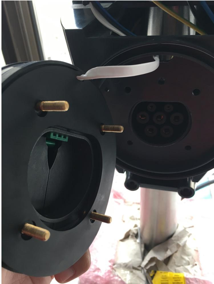
8/ Mettre en place le nouveau socle de prise en faisant passer le faisceau électrique dans le trou ovale prévu à cet effet.
