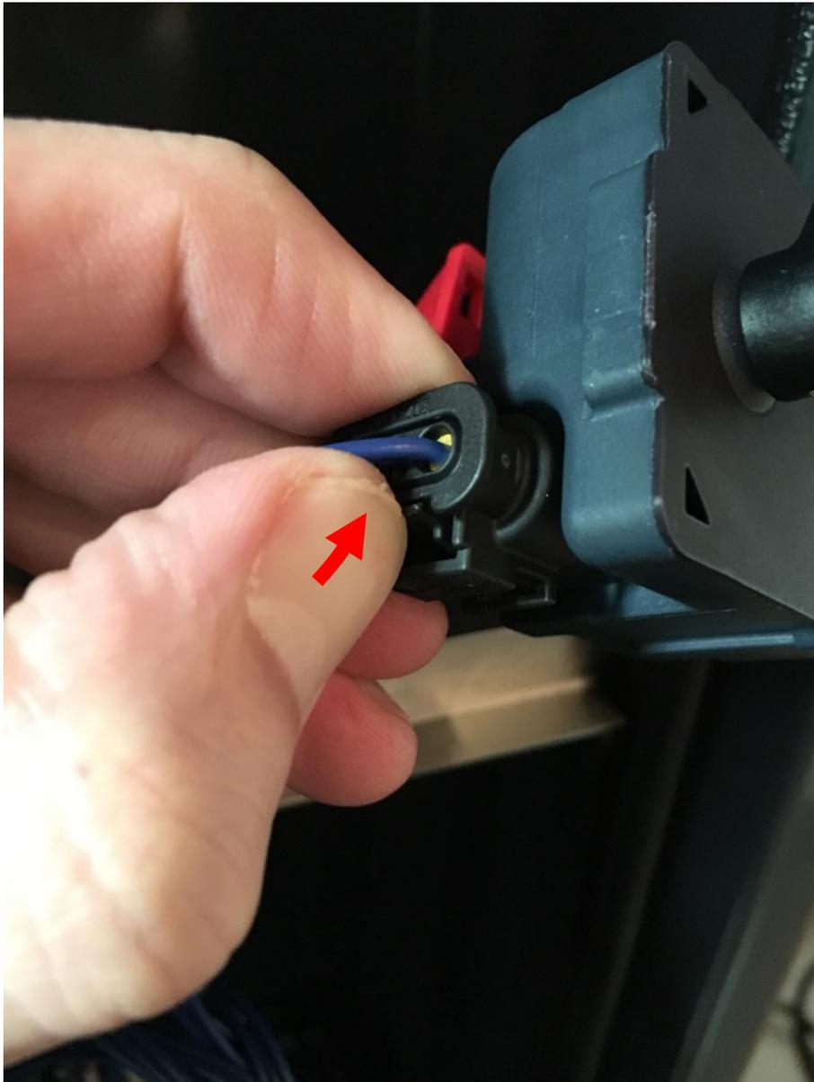
Appuyer sur la languette avec l'ongle et tirer sur le connecteur (ne pas tirer sur le câblage, bien saisir le connecteur lui-même), appliquer des petits mouvements gauche-droite si le connecteur ne se dégage pas facilement, tout en maintenant la pression sur la languette
