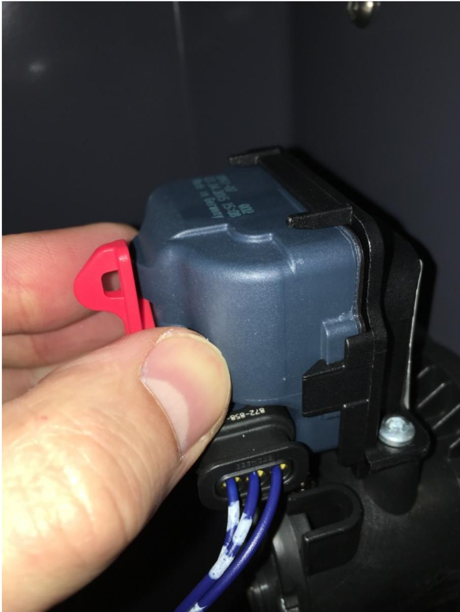
Appuyer sur le moteur fermement pour l'insérer en butée dans son logement
